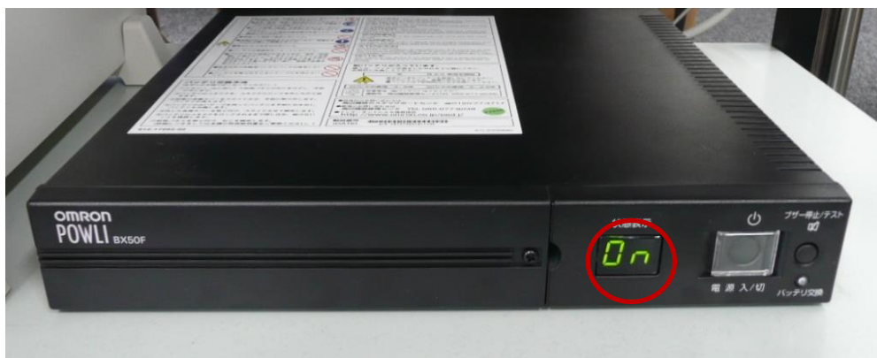
正常に起動した状態
