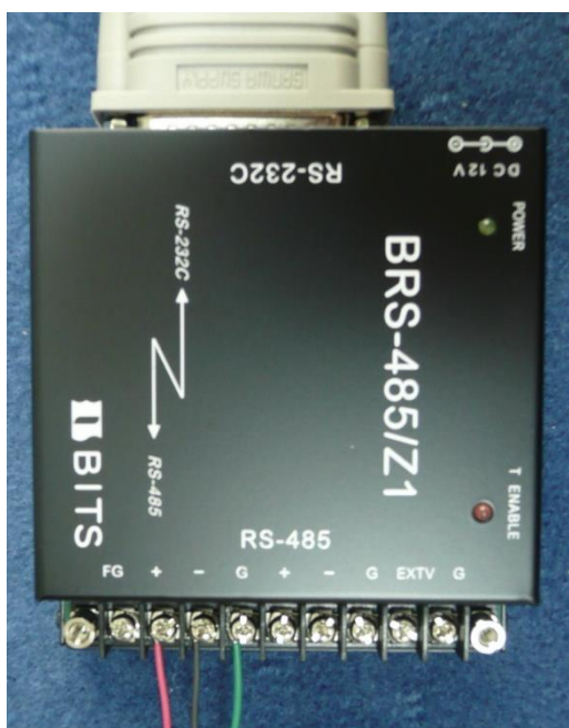
配線後の状態
