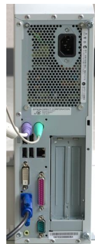
配線後の状態
