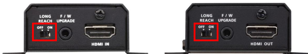
ローカル、リモート機の LONG REACH スイッチを ON へ変更
