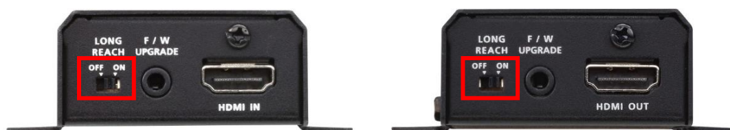
ローカル、リモート機の LONG REACH スイッチを ON へ変更
