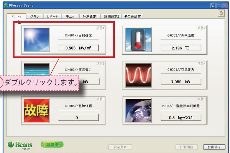
ホームタブ表示設定上のCH(チャンネル)項目上をクリックし(②)、ドロップダウンリストから表示したい項目を選択します(この場合、「交流電流」を選択)。
